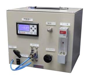
モバイルバッテリーを使用することで電源は必要ありません。また、 測定対象ガスのサンプリングに必要な部品をユニット化することで どこでも露点測定が可能です。
